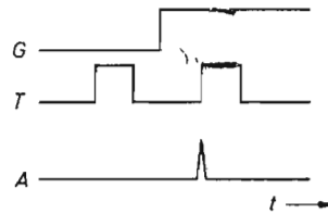
Figura 8.9 b . - Diagramma della successione delle commutazioni relativo alla Fig. 8.9 a .
